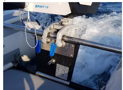
**Vanbrodski motori s dugim i posebno dugim osovinama, ne smiju se koristiti. Cijevi krme ne smiju se koristiti kao nosači za vuču. Za vuču se koriste samo prstenovi za vuču na krmi i pramcu plovila. Da bi se izbjegla oštećenja, bitno je osigurati blage promjene ubrzanja (dodavanja "gasa").**
