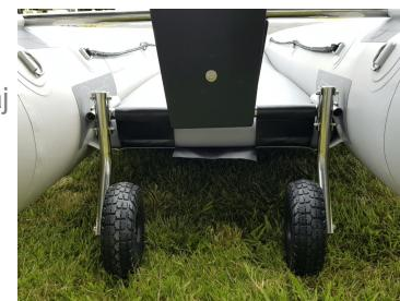
**Kotači za vrijeme vuče ne smiju biti smješteni ispod zračnih tubusa, jer ih mogu oštetiti. Klizni kotači dizajnirani su samo za težine plovila i samo za potrebu premještanja plovila na obali.**
