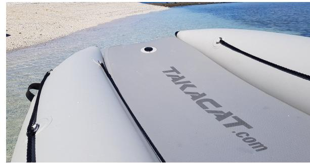
Modeli TAKACAT-LX po želji su dostupni i u 1 mm Hypalon / CSM (pneumatski tubusi + spojna podnica). Zbog potrebne tehnologije "Drop-Stich" (radni tlak 10 psi / 0,7bar), unutarnji visokotlačni pod u osnovi je izrađen od PVC-a s dodatnim PVC zaštitnim pokrovom od 1 mm.
