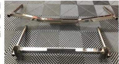
**3.3. Adapter za postavljanje vanbrodskih motora Mercury i Tohatsu,** komplet koji se sastoji od HPL visokotlačno laminiranog umetka za odgovarajući razmak na krmenoj ploči, te vijka (V4A-70) odgovarajuće dužine za povećanje debljine standardne krmene ploče.
