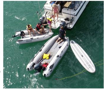
**Težina:** 50 kg. **Snaga motora** (kratka osovina): preporučena 10 - 15 KS, max. 20 KS. **Max nosivost:** 7 osoba, 715 kg. **Prenosivost:** 2 torbe, 90/35/25 cm (d/š/v), 18kg i 85/70/35 cm, 32 kg. **CE kategorija:** "C"
